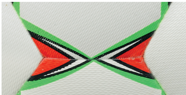
Hightech-PU, glänzend mit feinnarbiger Strukturoberfläche
